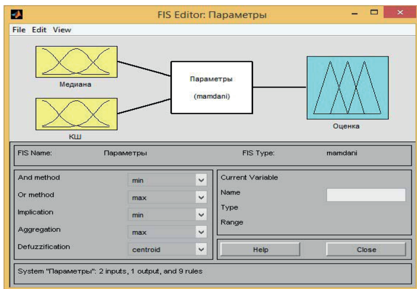
Рис. 1. Система для оценки качества деталей при варьировании зернистости кругов
