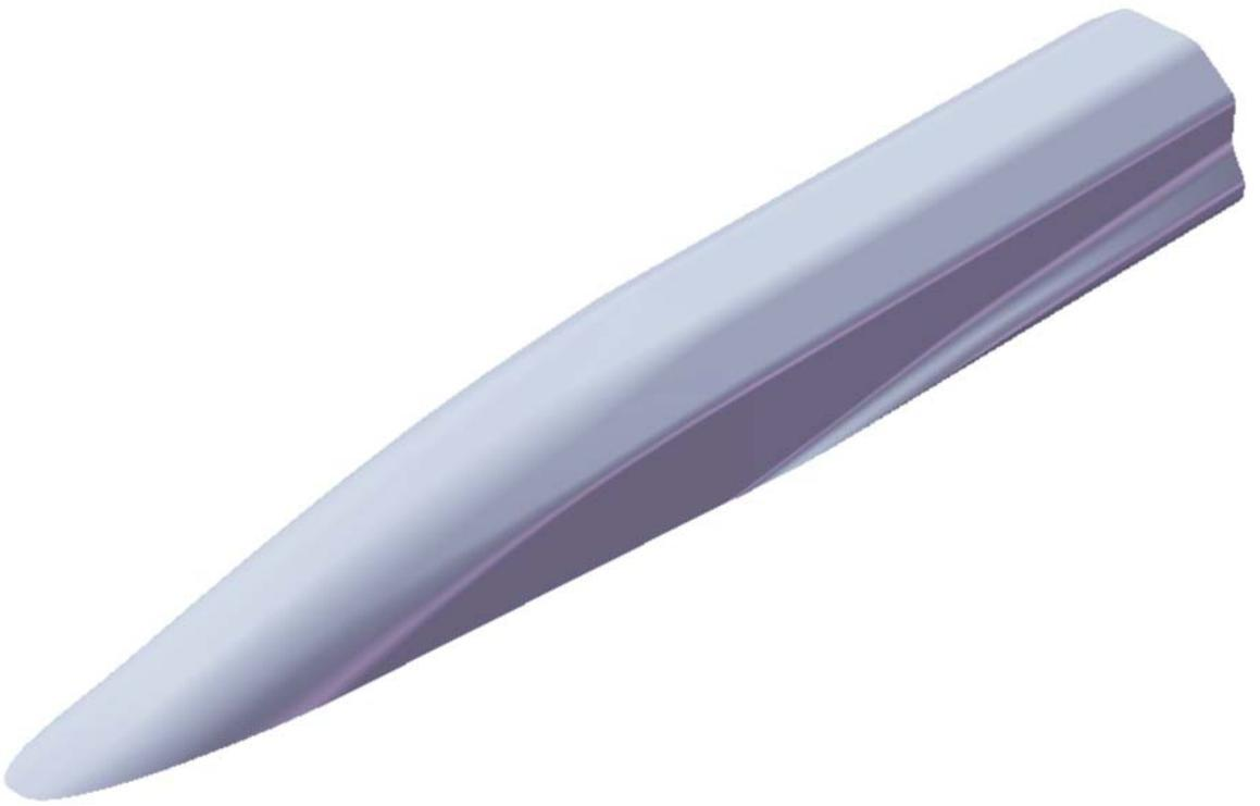
**Рис. 3. Предварительный вариант поверхности модели экспериментального беспилотного ГЛА X-51A. Вид в изометрии**
